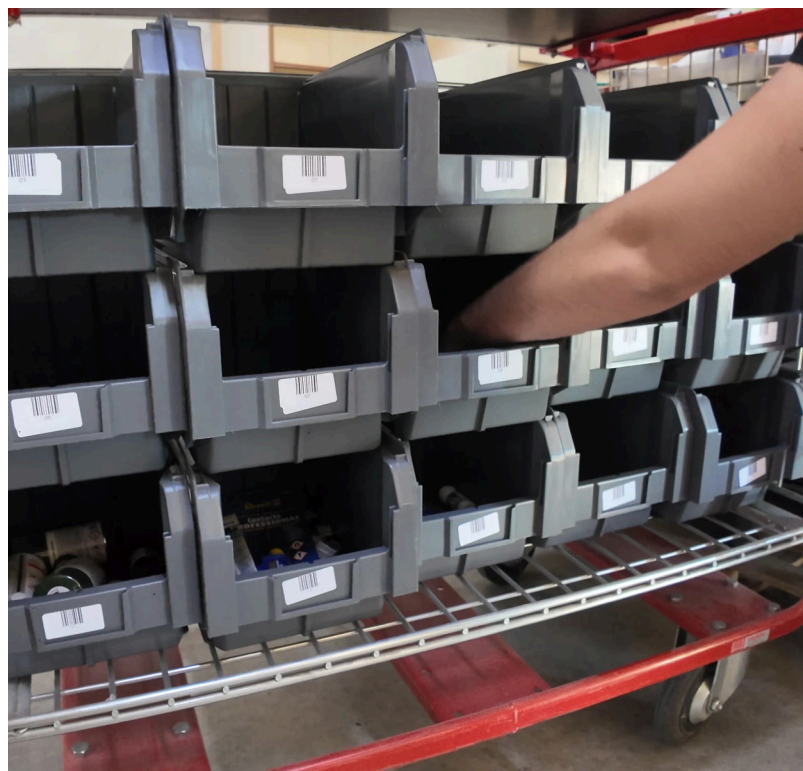
Sur le chariot des vagues multi-produits, un bac par commande, repéré par son code-barres.
